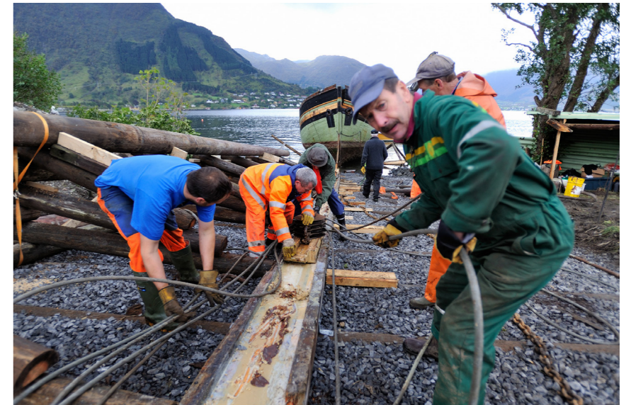
24. september 2011. Landsetting med to gravemaskiner, gio, mykje dugnadsfolk og tusen gode råd. Foto Bjarne Øymyr.
