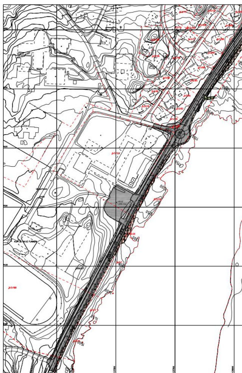
Figur 5. Utsnitt frå reguleringsplan for Opsangervegen som viser avkøyrsla mot Røsslandvegen.
