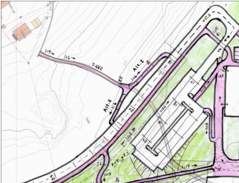
Figur 24. Skisse som viser mogleg løysing ved køyreveg og parkeringsplass. Høgder er vist med tal i vegbanen.
